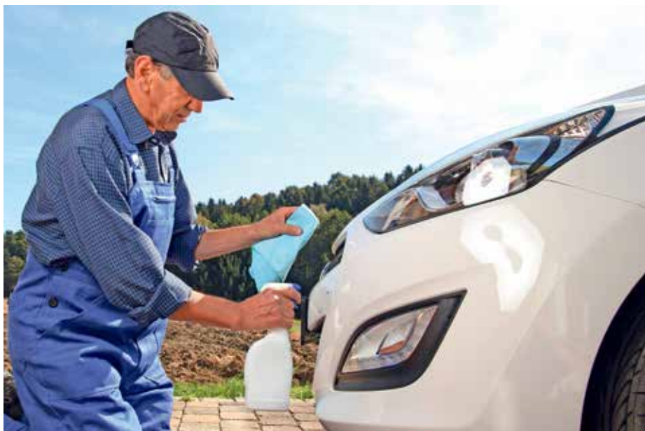
Verschmutzte Scheinwerfer blenden. Mit weichen Tüchern und viel Wasser kommt schnell wieder Licht ins Dunkel. Foto: ©RioPatura_Images/fotolia.com
