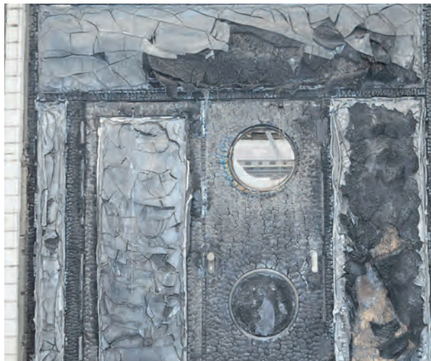
Nach einem Brandversuch lässt sich erkennen, wie Materialien reagiert haben.
